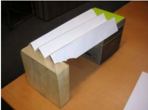
Aus Druckerpapier gefaltete tragende Struktur (Brücke)
