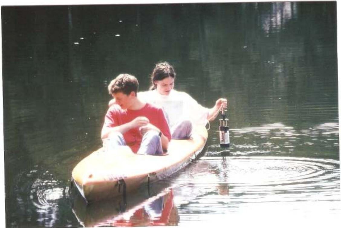
**Entnahme von Wasserproben für Tiefenprofiluntersuchungen im Haseesee**
