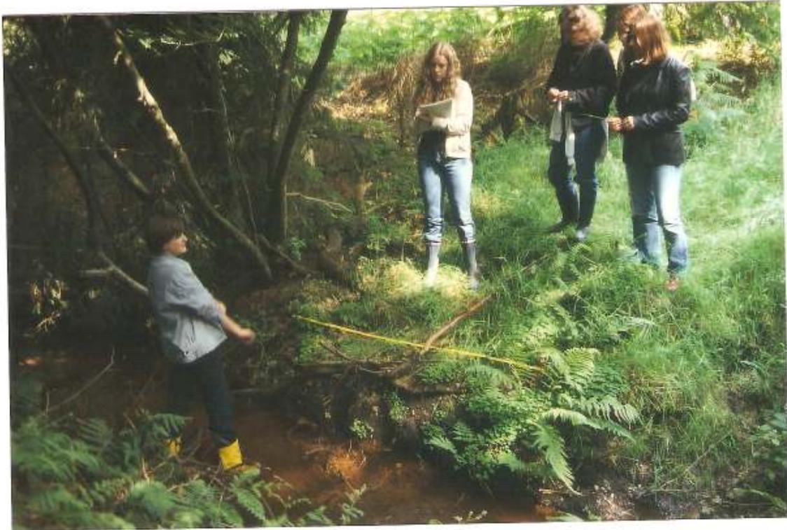
**Bestimmung der Fließgeschwindigkeit im Oberlauf des Börsteler Mühlenbaches**
