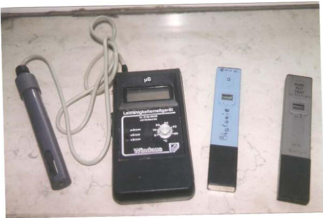
Leitfähigkeitsmessgerät und Leitfähigkeitssticks mit unterschiedlichen Messbereichen
