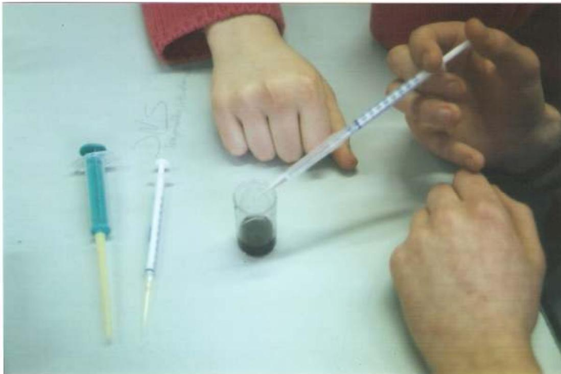
Die Benutzung der richtigen Spritzenspitze ist entscheidend für die korrekte Dosierung von flüssigen Reagenzien
