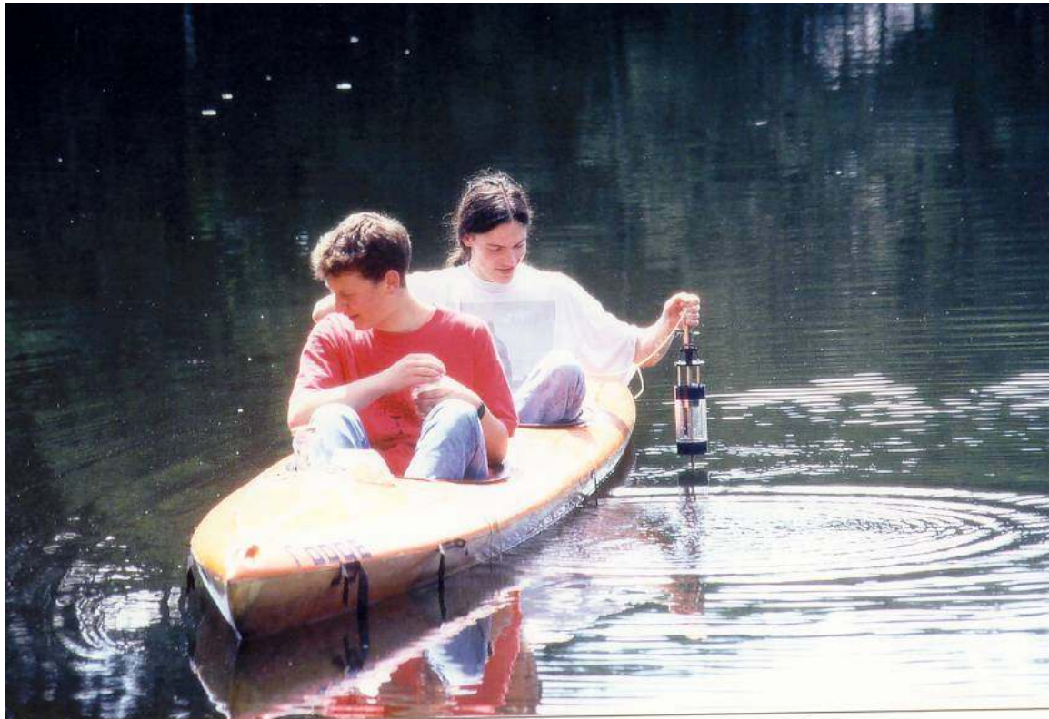
Sammeln von Wasserproben aus verschiedenen Tiefen eines Sees mit dem Ruttner-Schöpfer
