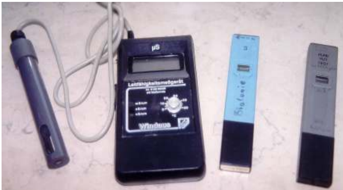
Leitfähigkeitsmessgerät und Leitfähigkeitssticks mit unterschiedlichen Messbereichen
