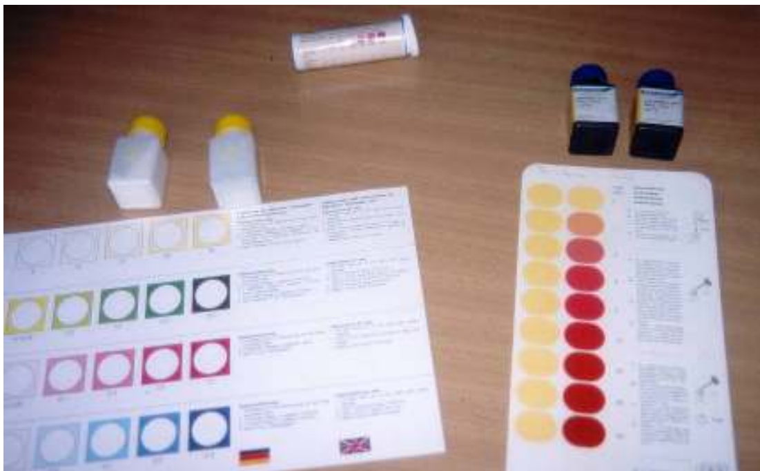
Nitrattests mit unterschiedlichen Messbereichen
