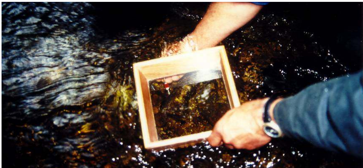
Beobachtung der Wasserströmung im Umfeld eines Steines durch Einbringen von Farblösung; der Guckkasten erlaubt eine durch Lichtreflexionen ungestörte Beobachtung
